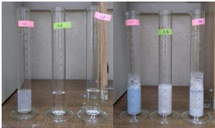
Рис.7. Определение устойчивости пены через 24 часа
