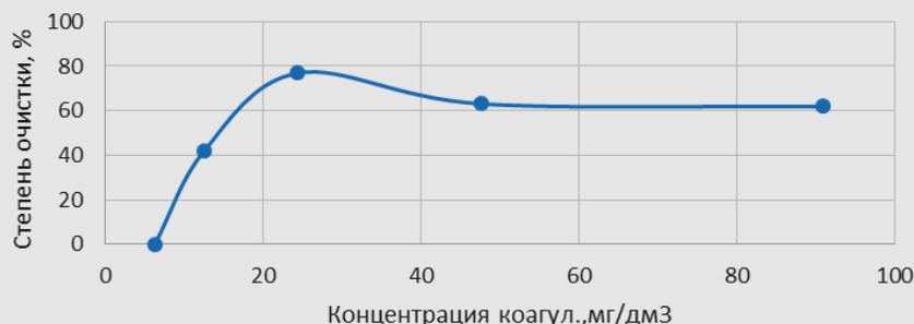
Рис. 2. Зависимость степени очистки воды от концентрации сульфата алюминия
