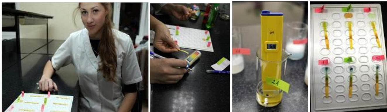
Рис.8. Определение pH среды исследуемых образцов с помощью индикаторной бумаги и pH-метра
