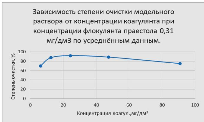
Рис. 5. Зависимость степени очистки воды от концентрации коагулянта при концентрации праестола 650 BC 0,31 мг/дм<sup>3</sup>
