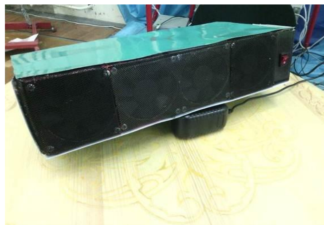
Рис. 1. Внешний вид установки очистки воздуха в индивидуальной рабочей зоне
