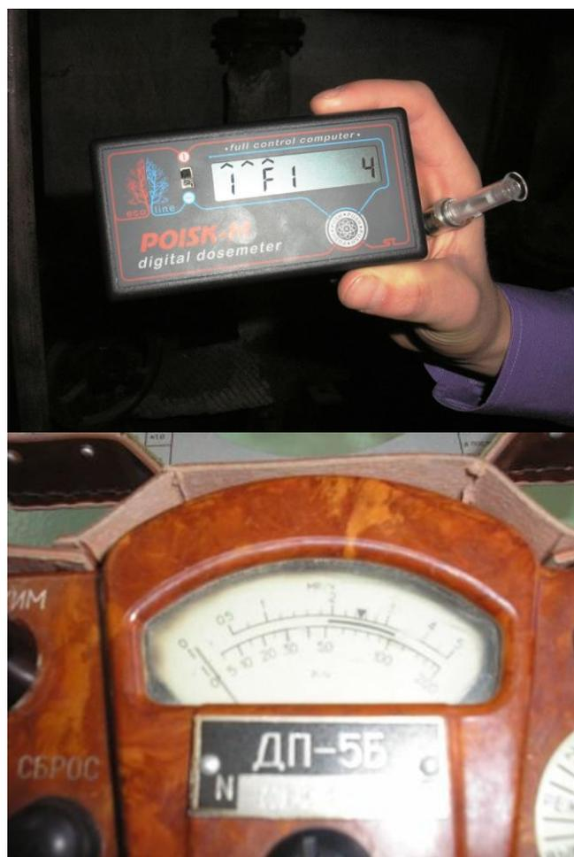
**Рис.4. Индикатор радиационный бытовой POISK-M. Дозиметр ДП-5Б**
